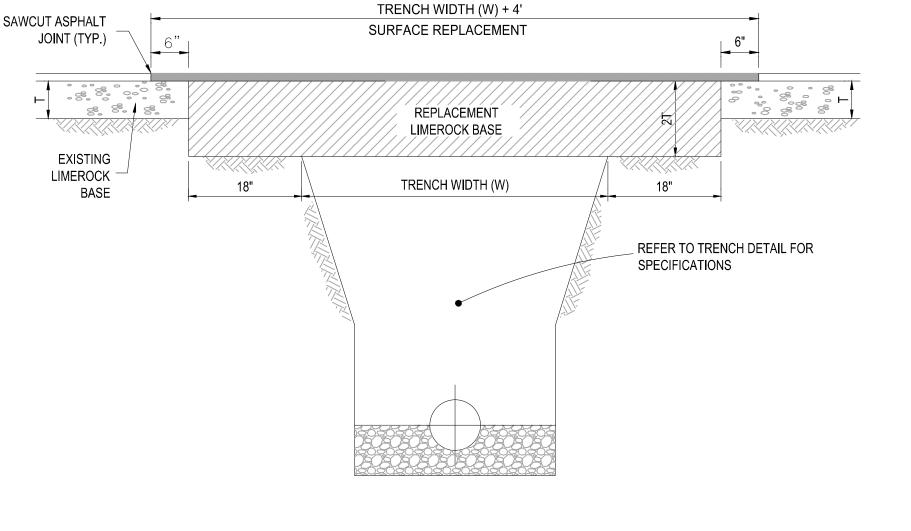
1. REPLACED BASE MATERIAL OVER TRENCH SHALL BE TWICE THE THICKNESS OF THE ORIGINAL BASE, MINIMUM 8", MAXIMUM 18".
